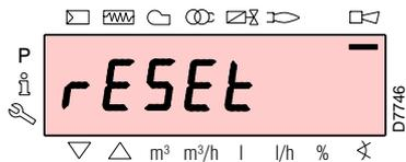
Betätigen Sie zum Entstören die Taste **"i/reset"** für 1s: auf dem Display erscheint **"rESEt"**.
