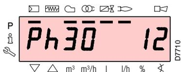
Das Display zeigt die verschiedenen Anfahren-, Ein- und Ausschaltphasen des Brenners an. Im nebenstehenden Beispiel zeigt das Display an, dass sich der Brenner in Phase 30 befindet (siehe im Diagramm von Abb. 34) und 12 s bis zum Übergang zur nächsten Phase fehlen.
