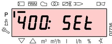
Rufen Sie die Parameterebene gemäß dem "Verfahren zum Zugang mittels Kennwort" auf. Das Display zeigt die Parametergruppe 400 an. Bestätigen Sie mit der Taste "i/reset".
