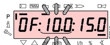
Halten Sie für den Stellmotor des Brennstoffs die Taste "F" gedrückt (die Position in Grad blinkt) und drücken Sie die Tasten "+" oder "-", um den Wert zu erhöhen oder zu verringern.
