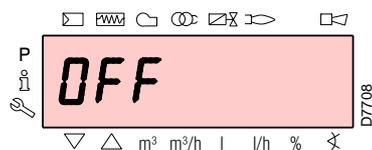
Der Brenner befindet sich im Wartestatus für Wärmeanfrage oder der Wahlschalter "0-1" in Abb. 28 steht auf Position "0".
