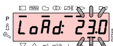
Halten Sie die Taste **"F"** gedrückt und erhöhen oder verringern Sie mit den Tasten **"+"** oder **"-"** den Prozentwert der Belastung.
