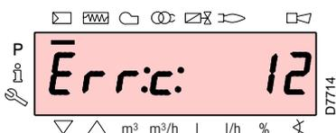
Das Display zeigt abwechselnd den Fehlercode (im nebenstehenden Beispiel **c: 12**) und die entsprechende Diagnose (im Beispiel **d: 0**) an. Das System schaltet in einen sicheren Zustand und es erscheint die in der nächsten Abbildung gezeigte Meldung.
