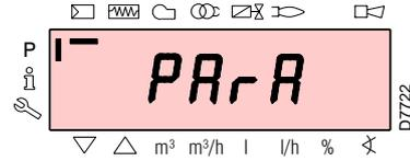
Wählen Sie die gewünschte Parametergruppe mit den Tasten "+" und "-", und bestätigen Sie durch Drücken der Taste "i/reset". Blättern Sie innerhalb der gewünschten Gruppe die Liste mit den Tasten "+" und "-" durch. Am Ende der Liste zeigt das Display "End" an.
