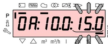
Halten Sie für den Stellmotor der Luft die Taste "A" gedrückt (die Position in Grad blinkt) und drücken Sie die Tasten "+" oder "-", um den Wert zu erhöhen oder zu verringern.
