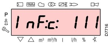
Das Display zeigt abwechselnd einen Code und eine Diagnose des Fehlers an, wobei das System nicht in einen sicheren Zustand versetzt wird.
