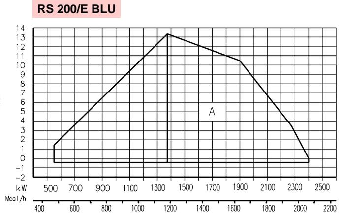
Die **Höchstleistung** muss innerhalb des Bereichs A (und B bei RS 120/E BLU) des Diagramms gewählt werden.
