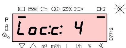
Am Brenner liegt eine Störabschaltung vor. Das Display zeigt abwechselnd den Störcode (im nebenstehenden Beispiel **c: 4**) und die entsprechende Diagnose (im Beispiel **d: 3**) an. Der rote Störanzeiger leuchtet.
